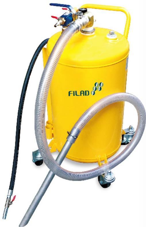
移動式高速廢油清理機，利用真空方式將廢油及雜質吸入桶內，再以氣壓方式將其排至儲存裝置內，可隨意移動於各機台之間，操作簡易、快速、清潔，可節省大量換油時間。
